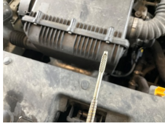
Motor, Yağ seviyesi > Eksik
