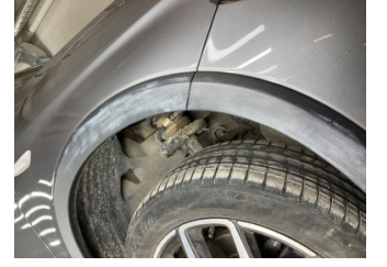
Çamurluk, sağ, Nikelaj, ızgara > Deforme Olmuş
