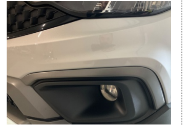
Tampon, ön, Ön tampon > Küçük Çizik
