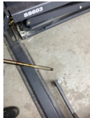
Motor, Yağ seviyesi > Eksik
