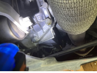
Şanzıman, Şanzıman > Yağ Kaçağı
