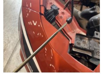
Motor, Yağ seviyesi > Eksik
