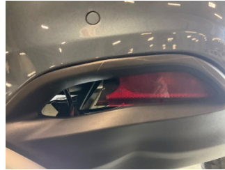
Tampon, arka, Reflektör, sağ > Hasarlı
