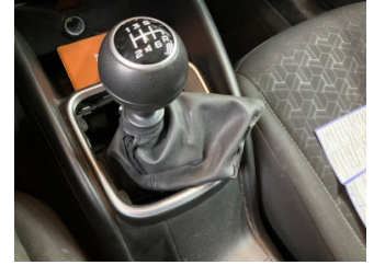
Şanzıman, Vites körüğü > Hasarlı
