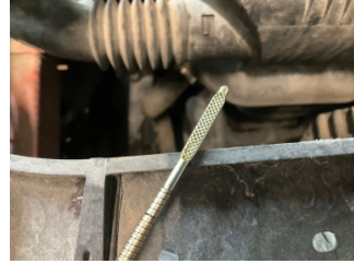
Motor, Yağ seviyesi > Eksik
