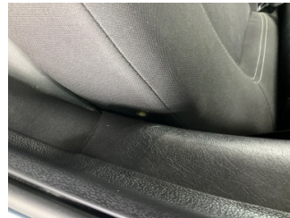
Döşemeler/Kapaklar, Döşemeler/Kapaklar > Yakıcı Madde Ile Zarar Görmüş
