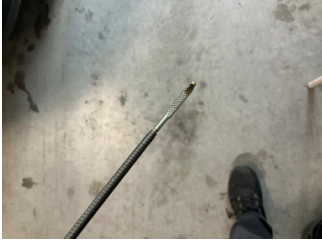
Motor, Yağ seviyesi > Eksik
