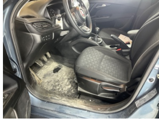
Döşemeler/Kapaklar, Döşemeler/Kapaklar > Kirlenmiş
