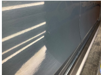
Kapı, sağ arka, Kapı, sağ arka > Ezik
