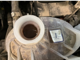
Motorsoğutması, Soğutma sıvısı > Kirlenmiş
