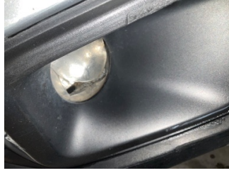
Sis lambaları, Sis farı camı, sağ > Hasarlı
