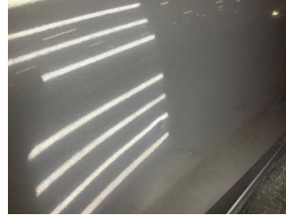
Kapı, sağ arka, Kapı, sağ arka > Ezik
