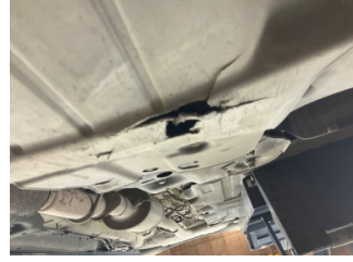
Motor, Alt muhafaza > Hasarlı
