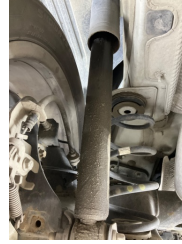
Arka aks, Amortisör, arka > Yağ Kaçağı
