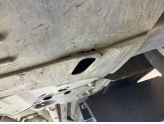
Motor, Alt muhafaza > Kırılmış
