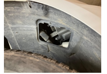
Çamurluk, sağ, Davlumbaz > Eksik
