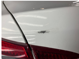
Bagaj kapağı/kapısı, Bagaj kapısı > Boyası Atmış
