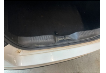
Döşemeler/Kapaklar, Yükleme eşiği kaplaması > Çizik
