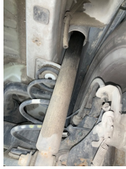
Arka aks, Amortisör, arka > Yağ Kaçağı
