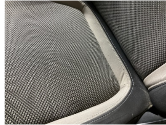
Döşemeler/Kapaklar, Döşemeler/Kapaklar > Yakıcı Madde Ile Zarar Görmüş
