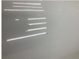
Kapı, sağ arka, Kapı, sağ arka > Çizik
