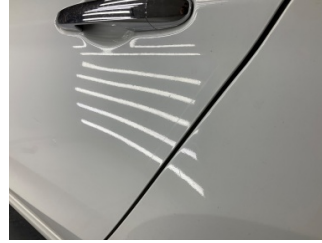
Kapı, sol arka, Kapı, sol arka > Çizik
