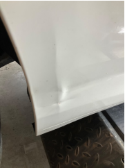
Marşbiyel, sağ, Marşbiyel, sağ > Hasarlı
