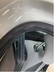
Kapı, sağ arka, Kapı fitili > Hasarlı
