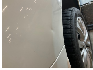
Çamurluk, sağ arka, Çamurluk, sağ arka > Ezik
