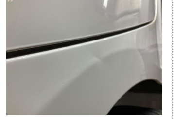
Çamurluk, sağ arka, Çamurluk, sağ arka > Ezik
