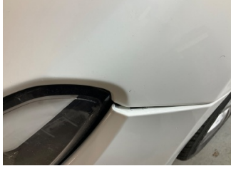
Tampon, ön, Ön tampon > Sabitlemesi Hatalı
