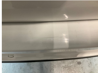
Tampon, arka, Arka tampon > Çatlak
