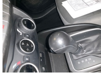
Şanzıman, Vites topuzu > Deforme Olmuş
