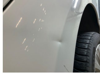
Çamurluk, sağ arka, Çamurluk, sağ arka > Ezik
