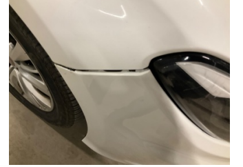
Tampon, ön, Ön tampon > Sabitlemesi Hatalı
