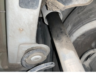
Arka aks, Amortisör, arka > Yağ Kaçağı
