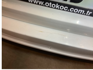
Tampon, arka, Arka tampon > Boyası Atmış
