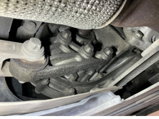
Şanzıman, Şanzıman > Yağ Kaçağı
