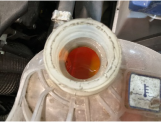
Motorsoğutması, Soğutma sıvısı > Kirlenmiş
