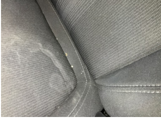
Döşemeler/Kapaklar, Döşemeler/Kapaklar > Yakıcı Madde Ile Zarar Görmüş
