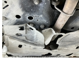
Motor, Alt muhafaza > Hasarlı
