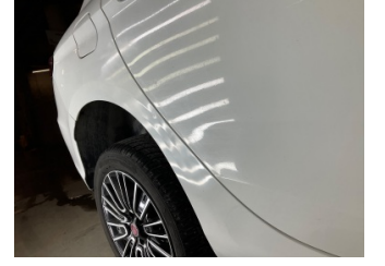
Çamurluk, sağ arka, Çamurluk, sağ arka > Ezik
