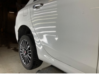
Kapı, sağ arka, Kapı, sağ arka > Ezik
