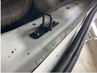
Arka bölüm, Arka sac/panel > Standart Dışı Onarım
