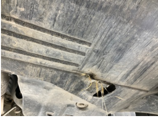
Motor, Alt muhafaza > Hasarlı
