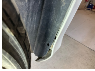
Çamurluk, sağ, Davlumbaz > Sabitlemesi Hatalı
