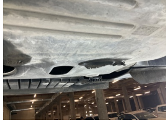
Motor, Alt muhafaza > Hasarlı
