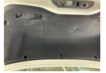
Döşemeler/Kapaklar, Döşemeler/Kapaklar > Deforme Olmuş
