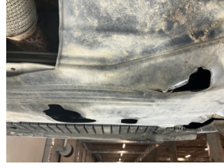
Motor, Alt muhafaza > Hasarlı
