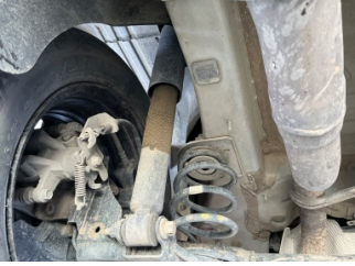
Arka aks, Amortisör körüğü, sol > Yağ Kaçığı
