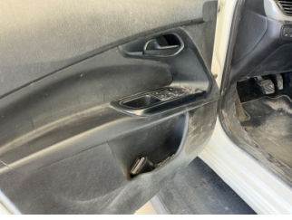
Döşemeler/Kapaklar, Döşemeler/Kapaklar > Deforme Olmuş
