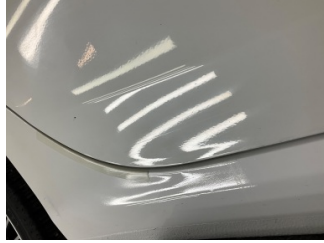
Kapı, sağ arka, Kapı, sağ arka > Çizik
