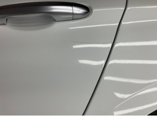
Kapı, sol arka, Kapı, sol arka > Yüzeysel Çizik
