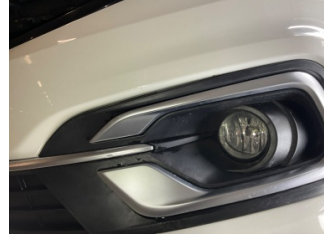
Sis lambaları, Sis Izgarası Sol > Sabitlemesi Hatalı
