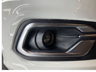
Sis lambaları, Sis Izgarası Sağ > Sabitlemesi Hatalı
