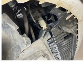
Tampon, ön, Tampon koruyucu orta > Hasarlı
