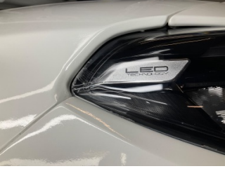
Farlar, Far camı, sağ > Çatlak
