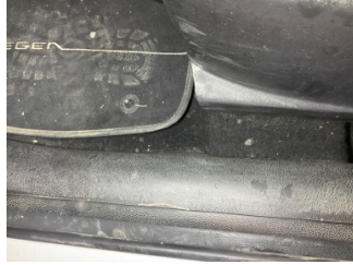
Döşemeler/Kapaklar, Döşemeler/Kapaklar > Yakıcı Madde Ile Zarar Görmüş
