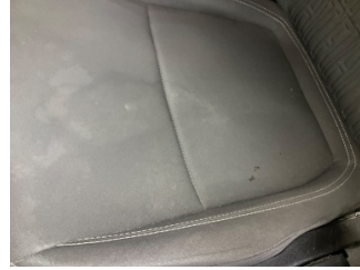
Döşemeler/Kapaklar, Döşemeler/Kapaklar > Yakıcı Madde Ile Zarar Görmüş
