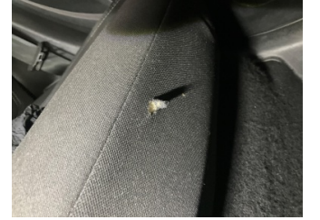
Döşemeler/Kapaklar, Döşemeler/Kapaklar > Yakıcı Madde Ile Zarar Görmüş
