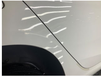
Çamurluk, sağ arka, Çamurluk, sağ arka > Ezik
