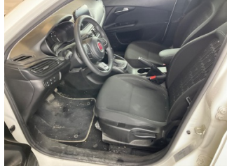
Döşemeler/Kapaklar, Döşemeler/Kapaklar > Kirlenmiş
