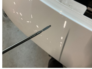
Motor, Yağ seviyesi > Eksik
