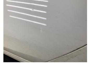
Kapı, sol arka, Kapı, sol arka > Çizik
