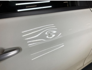
Kapı, sağ arka, Kapı, sağ arka > Ezik
