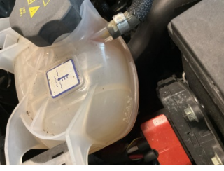
Motorsoğutması, Soğutma sıvısı > Eksik
