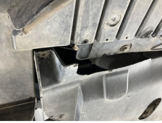
Motor, Alt muhafaza > Hasarlı
