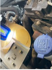
Motorsoğutması, Soğutma sıvısı > Eksik
