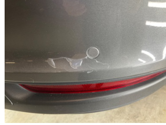
Tampon, arka, Arka tampon > Boyası Atmış
