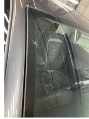
Camlar, Ön cam > Hasarlı
