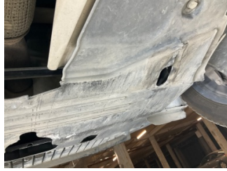
Motor, Alt muhafaza > Hasarlı
