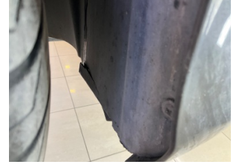
Çamurluk, sağ, Davlumbaz > Kırılmış
