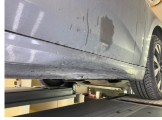
Marşbiyel, sağ, Marşbiyel, sağ > Hasarlı
