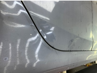
Kapı, sağ arka, Kapı, sağ arka > Ezik
