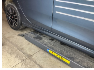
Marşbiyel, sağ, Marşbiyel, sağ > Hasarlı
