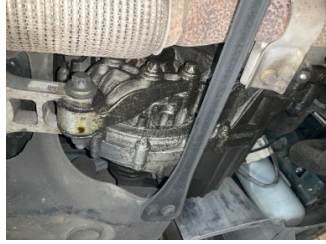
Şanzıman, Şanzıman > Yağ Kaçağı
