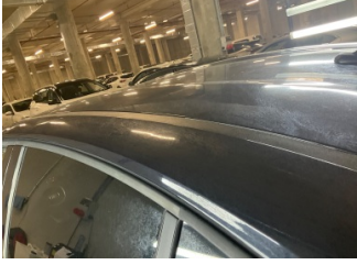
Kaporta, Kaporta > Dolu Hasarı
