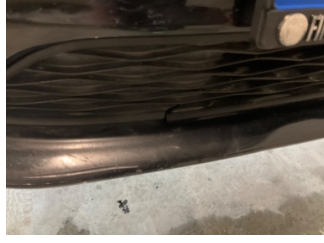
Tampon, ön, Ön tampon ızgarası > Kırılmış
