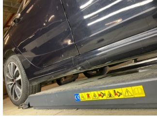
Marşbiyel, sağ, Marşbiyel, sağ > Hasarlı
