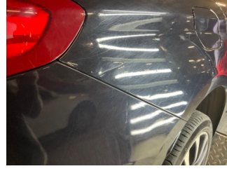
Çamurluk, sağ arka, Çamurluk, sağ arka > Ezik
