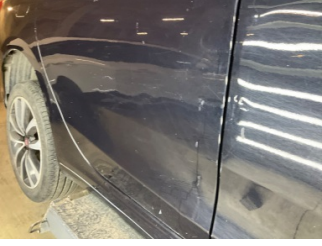
Kapı, sağ arka, Kapı, sağ arka > Ezik
