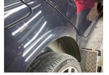
Çamurluk, sağ arka, Çamurluk, sağ arka > Ezik
