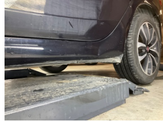
Marşbiyel, sol, Marşbiyel, sol > Hasarlı
