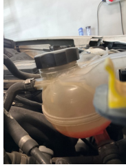
Motorsoğutması, Soğutma sıvısı > Eksik
