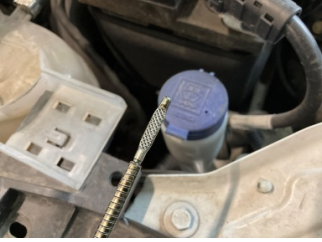
Motor, Yağ seviyesi > Eksik
