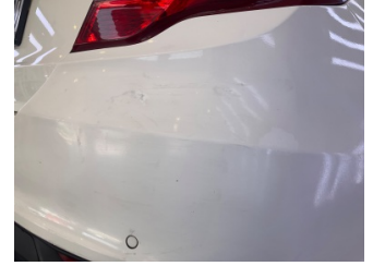
Tampon, arka, Arka tampon > Boyası Atmış
