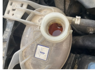
Motorsoğutması, Soğutma sıvısı > Kirlenmiş
