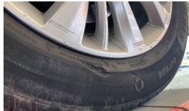
Tekerlek seti > Deforme Olmuş
