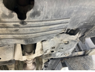
Motor, Alt muhafaza > Hasarlı
