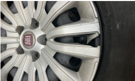
Jant kapağı seti > Hasarlı
