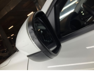
Dikiz aynası, sol, Dış dikiz aynası cerçevesi > Çizik
