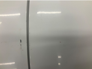
Kapı, sol arka, Kapı, sol arka > Çizik
