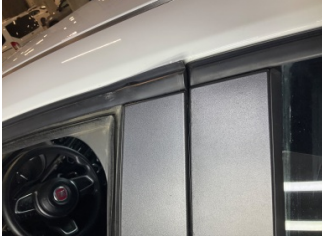
Kapı, sol ön, Kapı bandı > Sabitlemesi Hatalı
