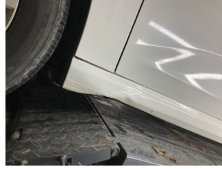
Marşbiyel, sol, Marşbiyel, sol > Hasarlı
