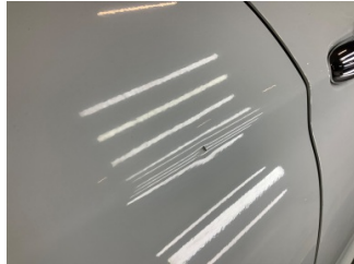
Kapı, sağ arka, Kapı, sağ arka > Çizik
