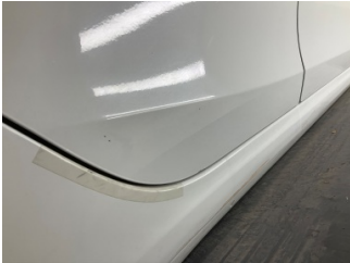
Kapı, sağ arka, Kapı, sağ arka > Çizik
