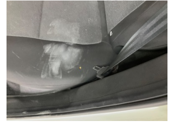
Döşemeler/Kapaklar, Döşemeler/Kapaklar > Yakıcı Madde ile Zarar Görmüş
