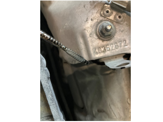
Motor, Yağ seviyesi > Eksik
