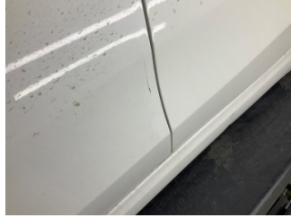
Kapı, sol ön, Kapı, sol ön > Ezik
