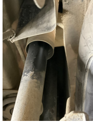
Arka aks, Amortisör körüğü, sağ > Yağ Kaçağı
