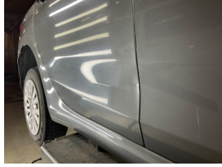
Kapı, sağ arka, Kapı, sağ arka > Ezik
