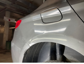
Çamurluk, sağ arka, Çamurluk, sağ arka > Ezik
