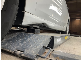
Marşbiyel, sol, Marşbiyel, sol > Hasarlı
