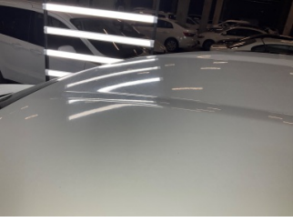
Tavan, Tavan > Dolu Hasarı
