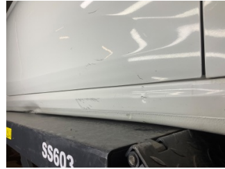
Marşbiyel, sağ, Marşbiyel, sağ > Hasarlı
