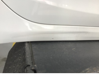
Marşbiyel, sol, Marşbiyel, sol > Hasarlı
