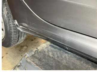
Marşbiyel, sağ, Marşbiyel, sağ > Hasarlı
