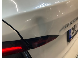
Bagaj kapağı/kapısı, Bagaj kapağı > Ezik
