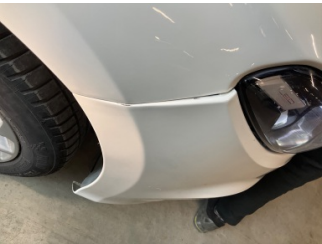
Tampon, ön, Ön tampon > Sabitlemesi Hatalı
