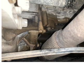
Motor, Motor > Yağ Kaçağı
