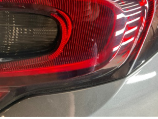
Arka lambalar, Arka lamba camı, sağ > Çatlak
